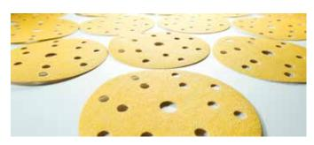
Этот стойкий универсальный классический материал прекрасно подходит для высокоскоростного шлифования в самых различных областях применения. Gold имеет полуоткрытую насыпку и специальное стеаратное покрытие для предотвращения засорения и образования комков, что позволяет достигать оптимального результата шлифования.
